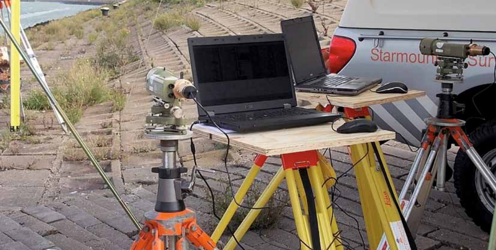
Fig. 6. De twee instrumenten, barcode baken en computers met draadloos netwerk tijdens de veldtest.
