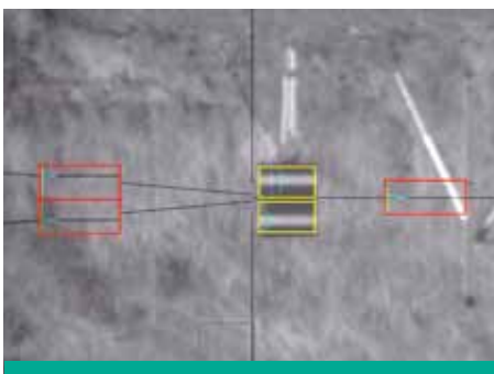
Fig. 4. Kruisdraad- (in rode rechthoeken) en richtmerkdetectie (gele rechthoeken). De Wild N3 heeft een omgekeerd beeld.
