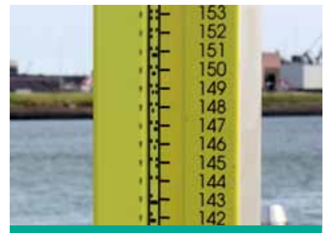
Fig. 5. De voor deze toepassing ontwikkelde INVAR barcode baak.
